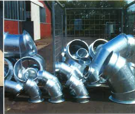
Verschiedene Bögen mit Flanschverbindung nachträglich feuerverzinkt
