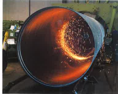
Fertigung von Wickelfalzrohren bis zu einem \varnothing von 2,0 Meter
