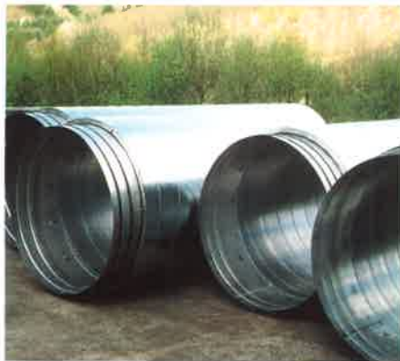
Doppelwandige Wickelfalzrohre geliefert für das Kernforschungszentrum in Cern
