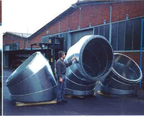
Segmentbogen 45°/90°/45° - doppelwandig, Auftrag MAN - Augsburg
