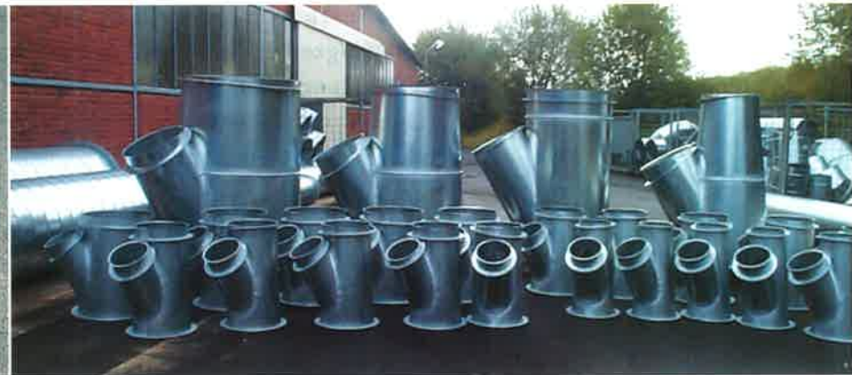
Konische Abzweigstücke 30° mit Flanschverbindung in Sonderausführung nachträglich feuerverzinkt
